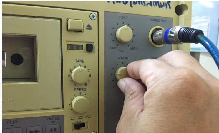
ภาพที่ ๔๐ การเปิดระดับเสียงสัญญาณเข้า ด้านหลังตัวเครื่อง เช่น เสียงจากคอมพิวเตอร์
