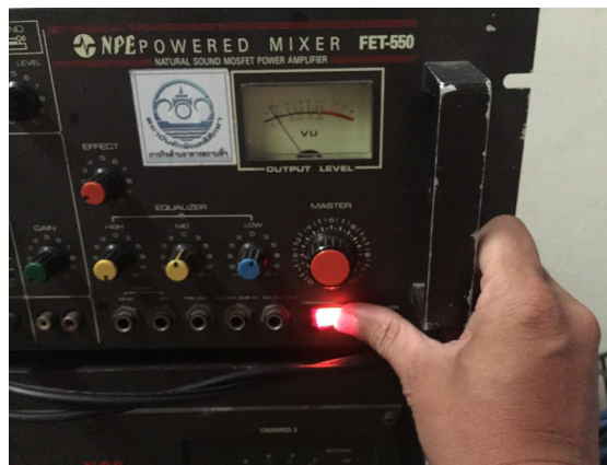
ภาพที่ ๑๙ การเปิดสวิตช์ Power On ที่ด้านหน้า มุมขวาล่างของเครื่องขยายเสียง
