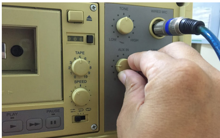
ภาพที่ ๕๖ การเปิดระดับเสียงสัญญาณเข้า ด้านหลังตัวเครื่อง เช่น เสียงจากคอมพิวเตอร์
