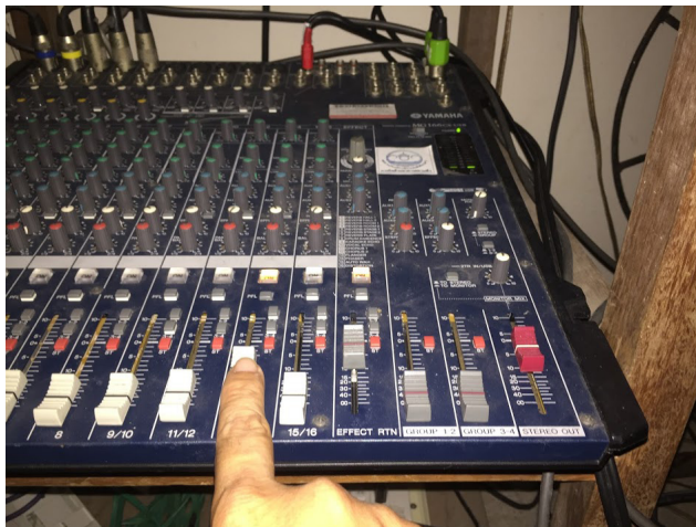
ภาพที่ ๒๑ การตรวจเช็คปรับระดับเสียงสัญญาณเข้าอื่นๆ เช่น เสียงจากคอมพิวเตอร์
