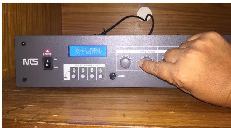
ภาพที่ ๔๗ การปรับระดับเสียงที่ช่อง Level Conference Microphone
