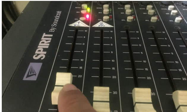
ภาพที่ ๖ การปรับระดับเสียงจากช่องที่นำสัญญาณเข้ามา
