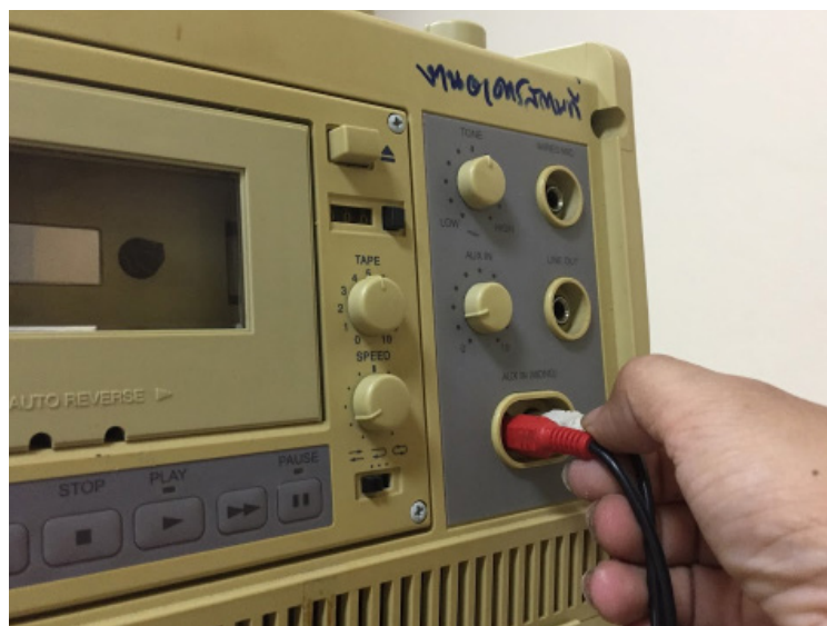
ภาพที่ ๕๓ การเสียบหัวสายสัญญาณนำเข้าอื่นๆ เช่น เสียงจากคอมพิวเตอร์
