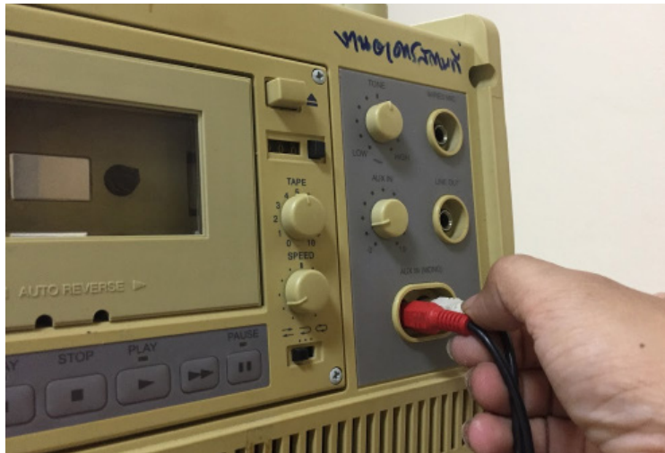
ภาพที่ ๓๘ การเสียบหัวสายสัญญาณนำเข้าอื่นๆ เช่น เสียงจากคอมพิวเตอร์
