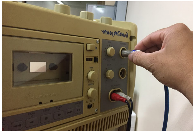
ภาพที่ ๕๒ การเสียบหัวสายสัญญาณนำเข้าไมค์สาย
