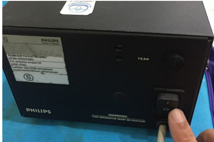
ภาพที่ ๓๑ การเปิดสวิตช์ Power On ที่หลังเครื่องควบคุมเสียง Conference
