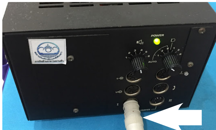
ภาพที่ ๒๙ การเสียบขั้วสาย ที่หลังเครื่องควบคุมเสียง Conference
