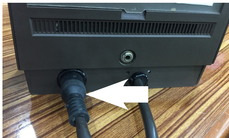
ภาพที่ ๓๐ การเสียบขั้วสาย ที่หลังชุดไมค์ Conference
