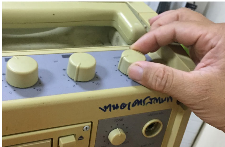
ภาพที่ ๔๑ การเปิดระดับเสียง Level ด้านบนตัวเครื่อง
