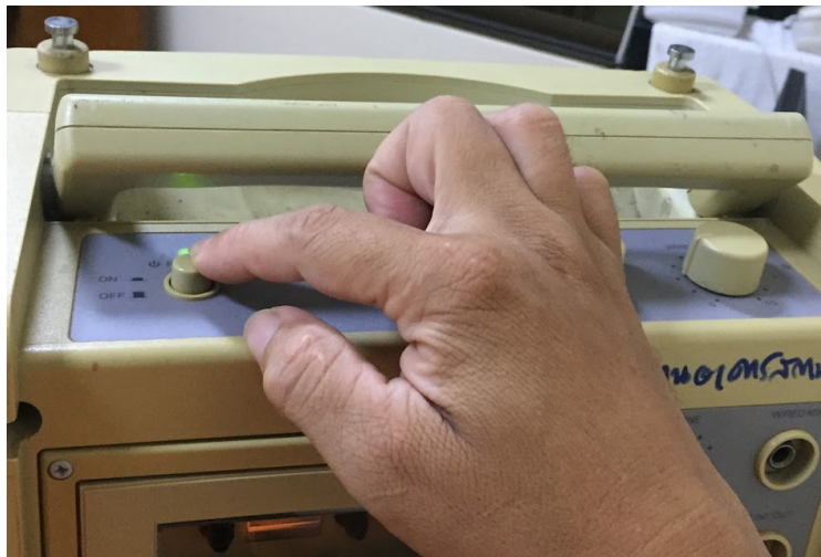
ภาพที่ ๕๕ การเปิดสวิตซ์ On ด้านบนตัวเครื่อง
