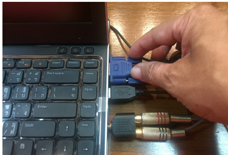
ภาพที่ ๖๐ การต่อสายสัญญาณจากเครื่องคอมพิวเตอร์ไปยังเครื่องฉายภาพ Projector
