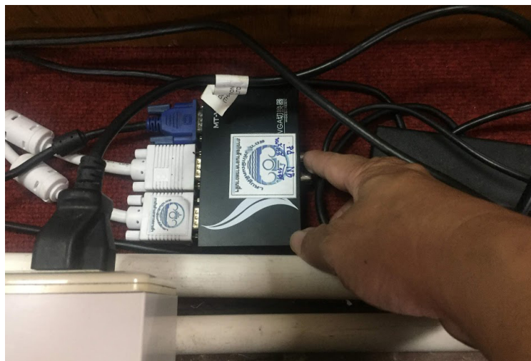
ภาพที่ ๖๗ การต่อสายสัญญาณจากเครื่องคอมพิวเตอร์และปุ่มเลือกสัญญาณไปยังเครื่องฉายภาพ Projector
