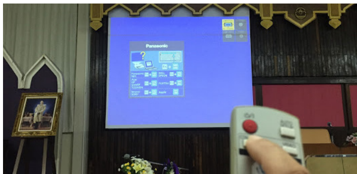
ภาพที่ ๗๗ การใช้รีโมทควบคุม กดที่ปุ่ม Source Search เพื่อหาสัญญาณ
