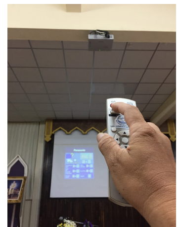
ภาพที่ ๗๐ การเปิดเครื่องฉาย Projector โดยกดที่ปุ่ม Power ที่รีโมทควบคุม
