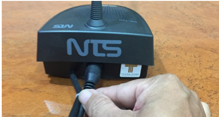
ภาพที่ ๔๕ ตรวจสอบเช็คขั้วสาย และสายชุดไมค์ Conference
