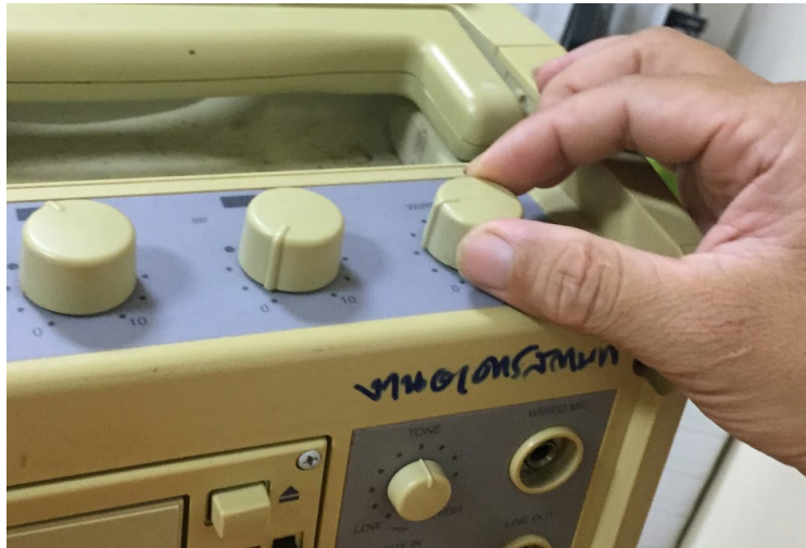
ภาพที่ ๕๗ การเปิดระดับเสียง Level ด้านบนตัวเครื่อง
