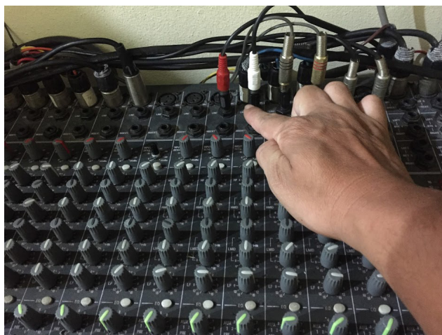
ภาพที่ ๘ ใช้คัตตำแหน่งนำเข้าเสียงสัญญาณเพิ่มเติม เช่น เสียงจากเครื่องอ่าน CD/DVD หรือเสียงนำเข้าจากคอมพิวเตอร์
