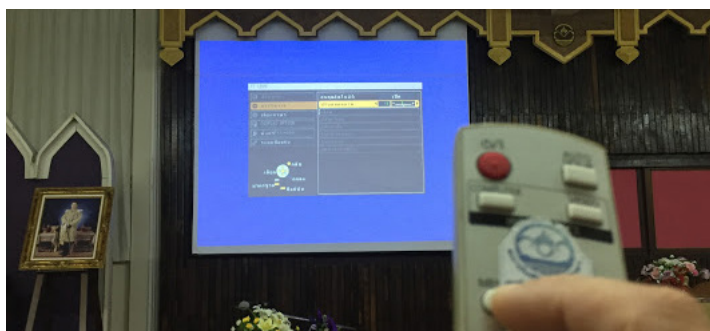
ภาพที่ ๗๘ การใช้รีโมทควบคุม กดที่ปุ่ม ย่อ หรือขยายภาพ
